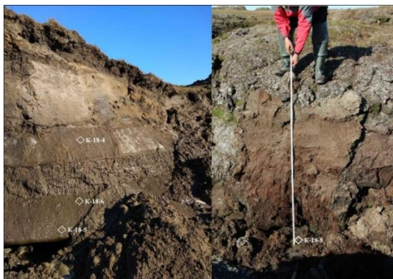
Рис. 5. Места отбора проб льда. Слева обнажение на берегу моря, сложенное сверху-вниз: 0-0,4 м – супесчаными почвами, 0,4-1,2 м – мелко-среднезернистыми песками, 1,2-1,6 м – пластовым льдом, 1,6-2,0 м суглинками со шлирами льда, 2,0-2,4 м – пластовым льдом. Справа торфяная пачка мощностью 2,2 м, в основании которой залегает ледовый комплекс
