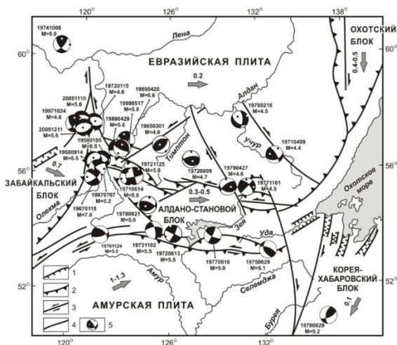
Рис.1. Принципиальная схема взаимодействия структур, развитых в зоне влияния Евразийской и Амурской литосферных плит по [1, 2, 4]. 1–4 – разломы: 1 – сбросы, 2 – взбросы и надвиги, 3 – сдвиги, 4 – неустановленной кинематики. Стрелками показаны направление движения плит и блоков, рядом их скорость смещения (см/год) по геодезическим и GPS данным.
