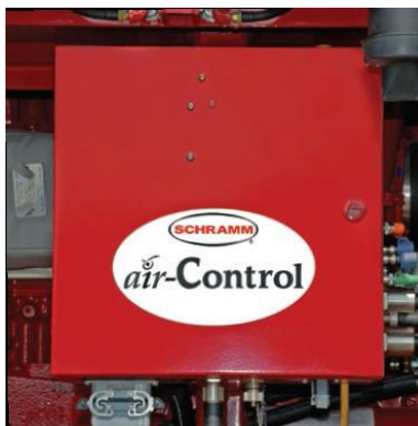
Рис. 2. Система оптимизации производительности компрессора Air-Control™ позволяет экономить до 12% топлива
